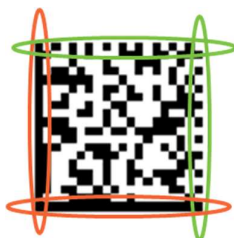
Rysunek 4-17 Przykład wzorca wyszukiwarki Data Matrix
