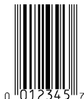
Rysunek 5.2.2.4 - 1 Symbol kodu kreskowego UPC-E (kodujący 001234000057 poprzez pominięcie zer)
