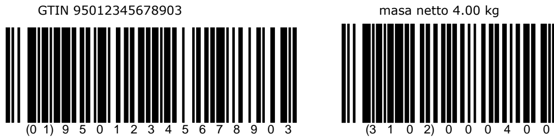
Rysunek 7.8.5.2.-2 Łączenie danych w symbolice GS1 -128
