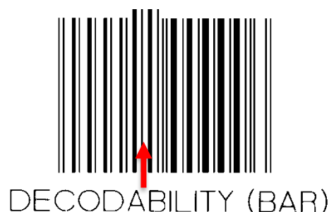
Rysunek 5.12.5.12 - 3 Symbol kalibracji z zaaranżowaną niską oceną dekodowalności
