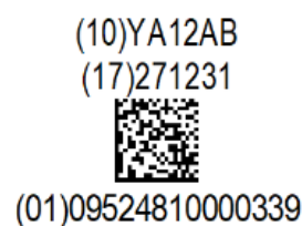
Rysunek 4.14-3. Przykład rozmieszczenia podzielonego HRI
