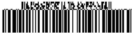
Rysunek 5.11.8 - 9 Symbol GS1-128 z czterokolumnowym CC-A
