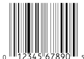
Rysunek 5.2.2.3 – 1 Symbol kodu kreskowego UPC-A
