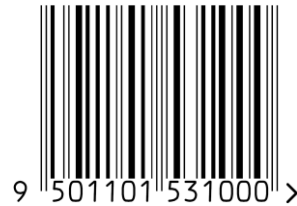
Rysunek 5.2.2.1 – 2 Symbol kodu kreskowego EAN-13
