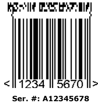
Rysunek 5.11.8 – 3 Symbol EAN-8 z trzykolumnowym CC-A
