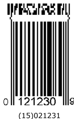
Rysunek 7.8.5.3.-2 Przykład połączenie symbolik kodów GS1 (GTIN- zakodowany w UPC-E, data "Best before" w symbolice kompozytowej)
