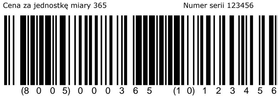
Rysunek 7.8.5.2.-1 Łączenie danych w symbolice GS1 -128
