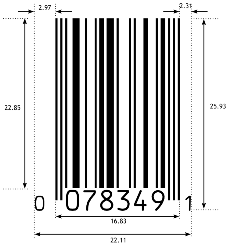
Rysunek 5.2.6.6 - 4 Symbol kodu kreskowego UPC-E
