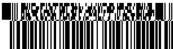
Rysunek 5.11.2-2 Symbol Złożony GS1-128 z CC-C
