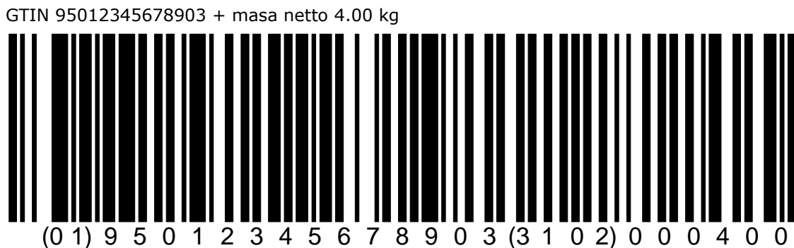
Rysunek 7.8.5.2.-2 Łączenie danych w symbolice GS1 -128
