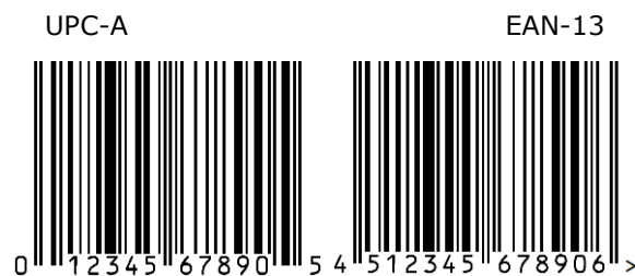
Rysunek 5.1 – 1 Symbole kodów kreskowych UPC-A i EAN-13
