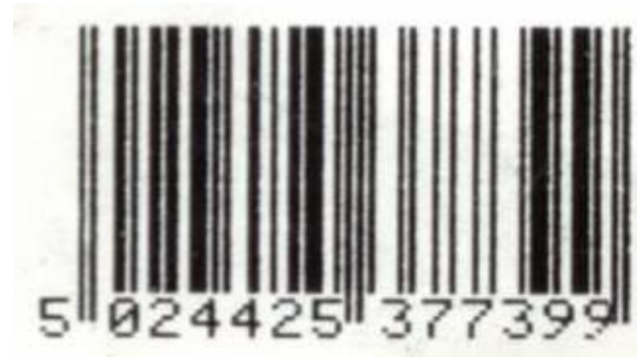
Rysunek 5.12.5.12 – 1 Symbol z problemem w określeniu krawędzi
