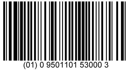
Rysunek 5.1 – 3 Symbol kodu kreskowego GS1-128
