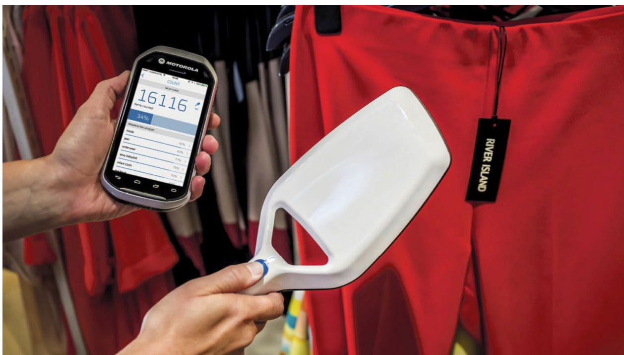
Rys. 48. Przykład urządzeń wykorzystywanych w procesie inwentaryzacji w sieci River Island
